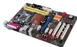
**Чипсет** (англ. chipset) — набор микросхем, спроектированных для совместной работы с целью выполнения набора заданных функций. Обеспечивает взаимодействие центрального процессора с различными типами памяти, устройствами ввода-вывода, контроллерами и адаптерами периферийных устройств.
