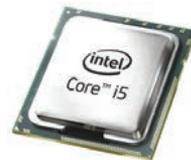
**Процессор** – это электронная микросхема, состоящая из множества полупроводниковых элементов (кристаллов), управляющая работой каждого устройства компьютера, а также выполняющая все вычисления и обработку информации на нем. Полупроводниковый кристалл выполняется из особо чистого кремния. При его изготовлении используют высокоточные технологии.
